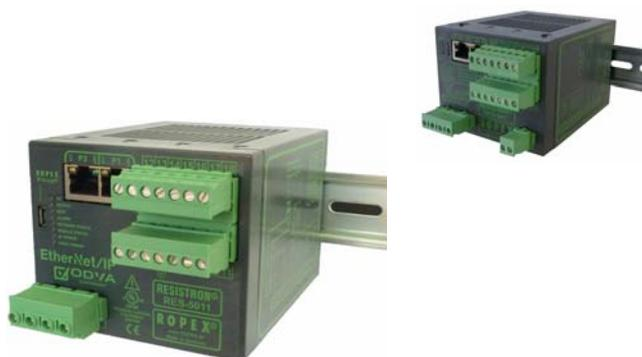
Der neue RESISTRON-Temperaturregler RES-5011 (ab Produktionsdatum 04/2016) wurde mit einem leistungsfähigeren Prozessor ausgerüstet, um damit neue Funktionalitäten zu ermöglichen. Des Weiteren sind neue Funktionen und Schnittstellen integriert worden, und eine Zulassungen für den amerikanischen und kanadischen Markt ist vorhanden. Der RES-5011 ist in
