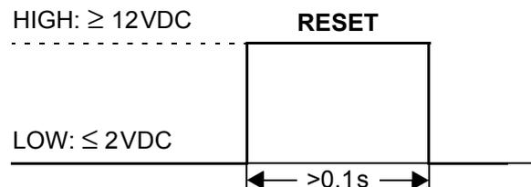
Während der Aktivierung des „RESET“-Signals geht bei Reglern ab SW-Revision 103 der Istwert-Ausgang auf 0...3 °C (d.h. ca. 0VDC). Dies kann von der übergeordneten Steuerung (z.B. SPS) als Rückmeldung ausgewertet werden.
