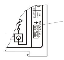
Codierschalter zur Anpassung der Sekundärspannung  $U_{\scriptscriptstyle 2}$ , in den für Ihre Anwendung geeigneten Spannungbereich einschalten . Bei Sekundärströmen über 80 A, muß zusätzlich Schalter 5 eingeschaltet werden.
